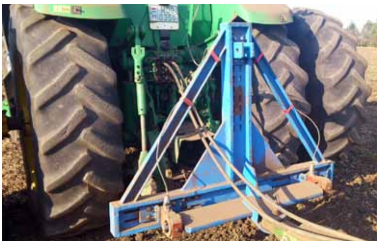
Obr. 4) Mechanická časť meracieho zariadenia ťahového odporu.
