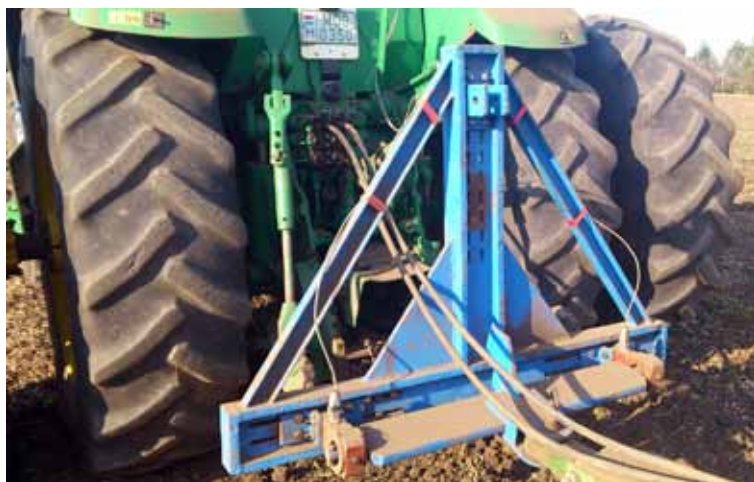
Obr. 4) Mechanická časť meracieho zariadenia ťahového odporu.
