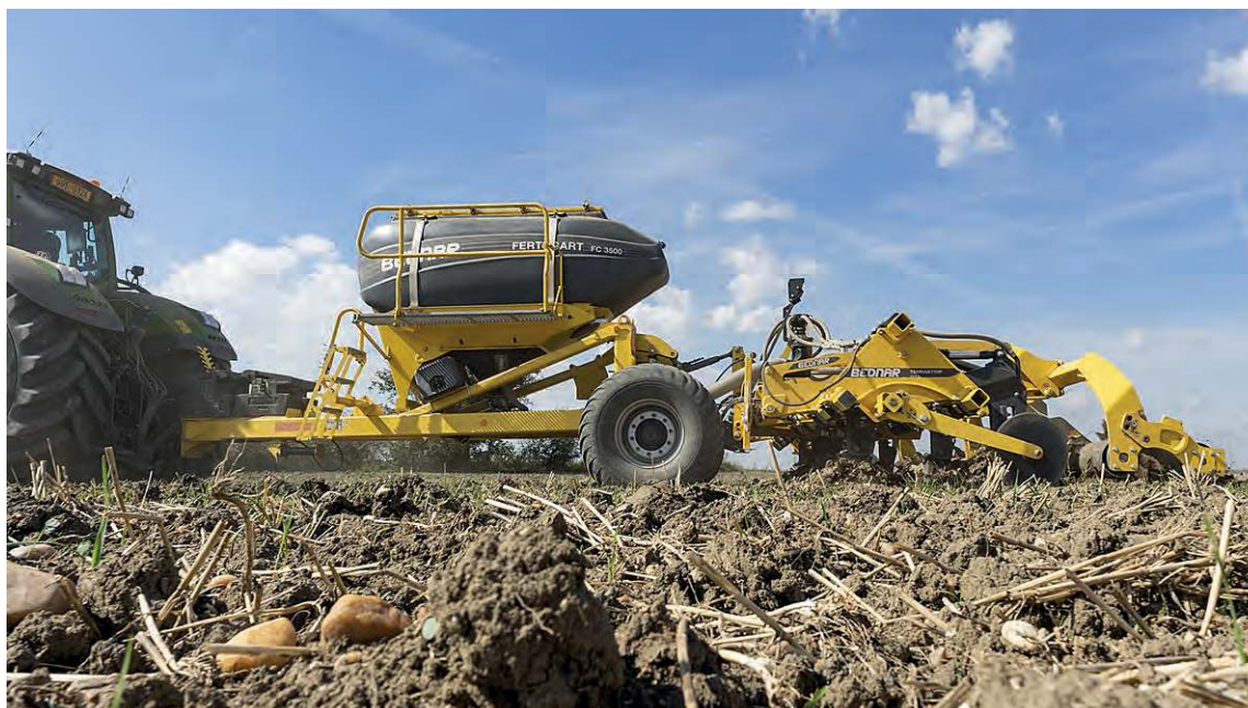
Řádkový kypřič TERRASTRIP ZN zpracovává půdu v pásech, ve kterých jsou pěstovány řádkové kultury (kukuřice, slunečnice, cukrová řepa apod.).
