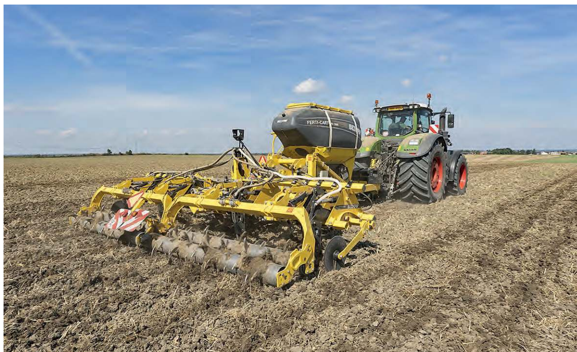
Řádkový kypřič TERRASTRIP ZN 8/75 agregovaný se zásobníkem na hnojivo FERTI-CART FC 3500.
